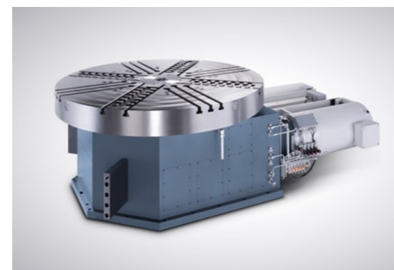
TRT 1000 (∅ 2.000 mm, 2×51 kW, 12.000 Nm, 15 t, 250 U/min)
